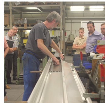
Gauche: production de pièces sur plieuse; Droite: un ouvrier explique comment le chariot d'une scie à panneaux assemble les différentes pièces
