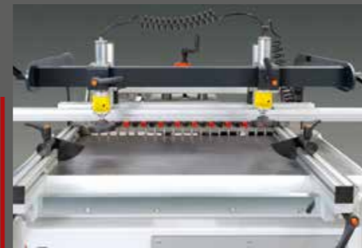
Aluminium regel 3000 mm met 4 wegklapbare aanslagen.
