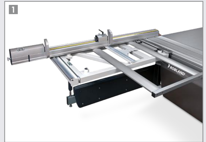
Ogranicznik poprzeczny wysięgnika stołu Nowy, duży stół z ukośnie ustawianym ogranicznikiem i skalą.
