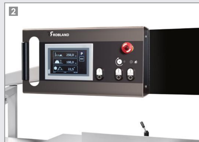
Panel obsługi z 7" wyświetlaczem umieszczony na poziomie wzroku do sterowania 3 osiami.
