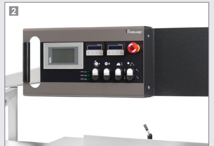
Panel obsługi z 7" wyświetlaczem umieszczony na poziomie wzroku – do sterowania ogranicznikami równoległymi. Z opcjonalnym Digipack X1 (Cyfrowy odczyt ustawienia ukośnego i regulacji wysokości tarczy piły).
