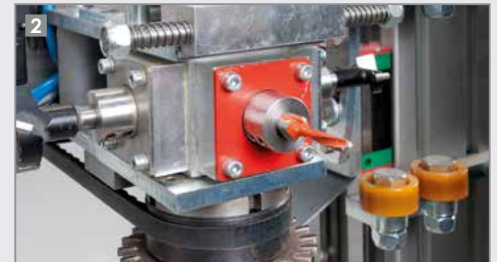
Lewe wiertło 5 mm do wiercenia otworów szeregowych
